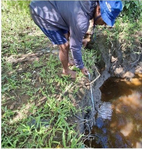
Pengukuran ketinggian badan sungai di Distrik Mimika Timur
