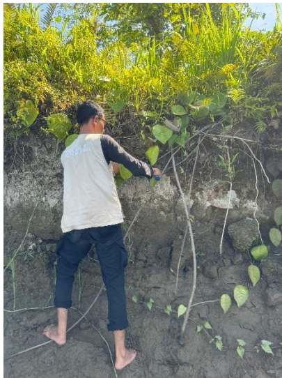
GAMBAR 5.3 Singkapan Batulempung dan Proses Pengambilan Sampel
