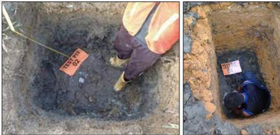
Gambar 4.4. Pembuatan sumur uji dengan dimensi 80 x 120 cm
