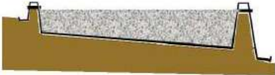
Gambar 6.10. Dasar kolam miring ke arah outlet
