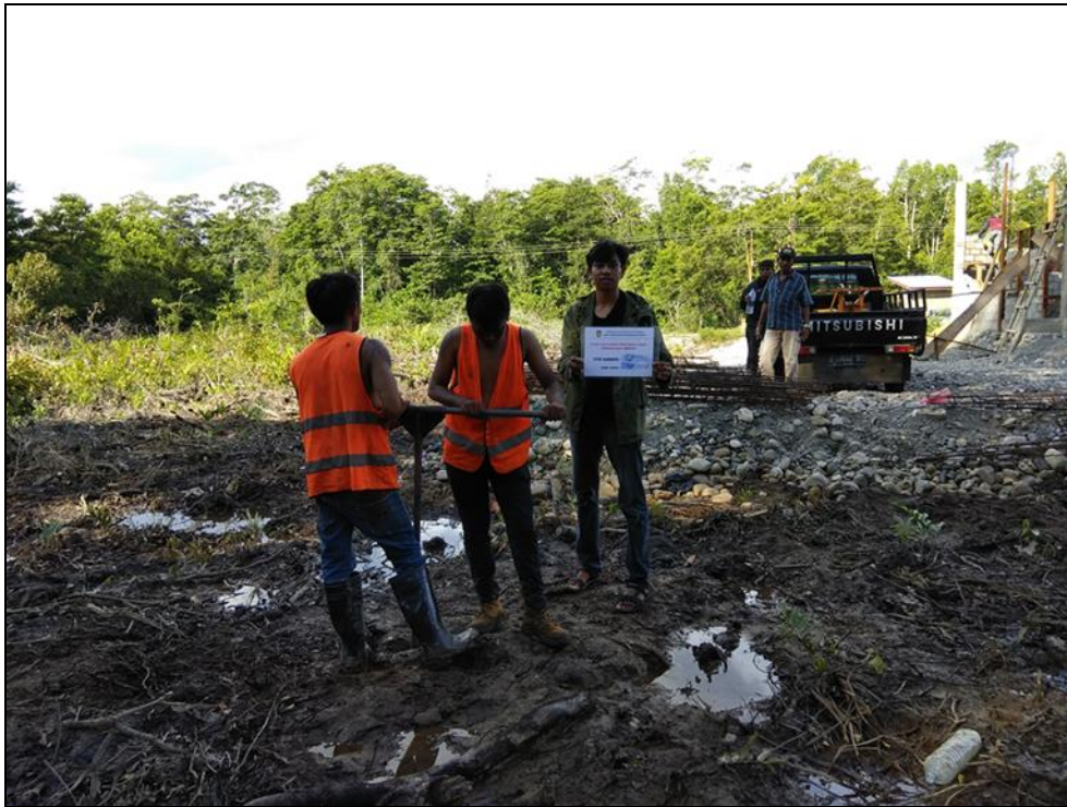
Gambar 5.6 Pengambilan Sampel tanah dengan Alat Handbore
