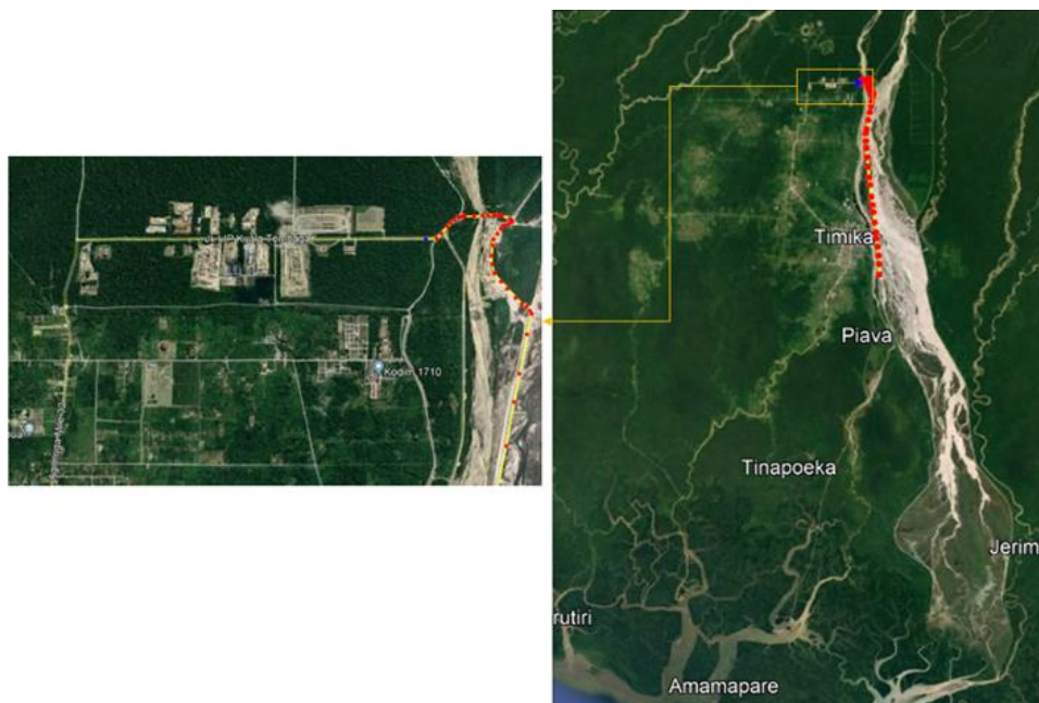
Gambar 5-13 Rute Pengangkutan Tailing dari ModADA ke Stockpile
