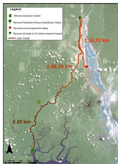
Gambar 5-12 Alternatif Skenario 2 Skema Pengangkutan Tailing dan Hasil Pengolahan Tailing Separator
